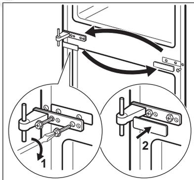
11. Снимите верхний ограничитель и установите его на противоположной стороне.
