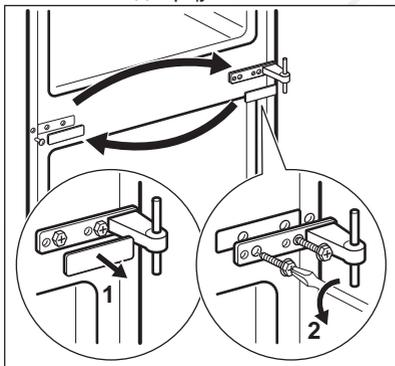
7. Снимите крышку и заглушки нижней петли, а затем отвинтите скобу нижней петли.
